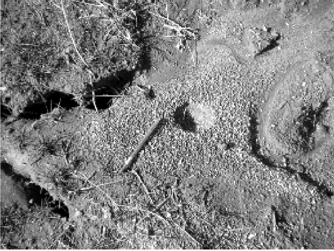
Şekil 7. Alaköy yakınında sıvılaşıp yüzeye çıkan orta-iri kum malzemesi.
