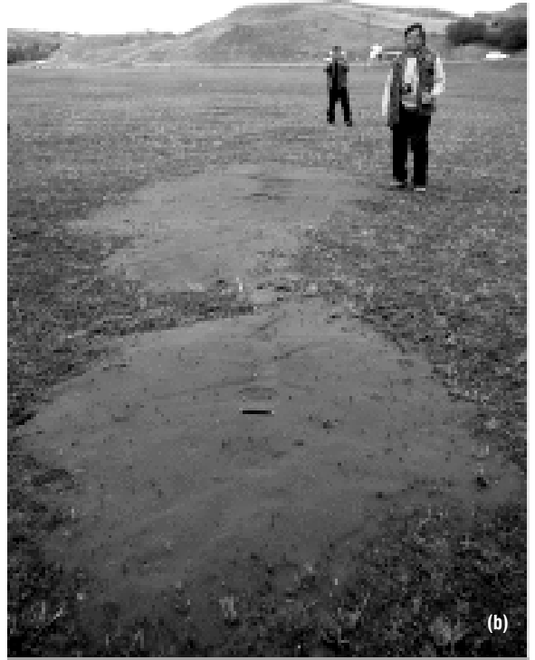
Şekil 10. Sıvılaşma dolayısıyla oluşan çatlaklar boyunca çıkan kumlar: (a) sıvılaşma sonucu ince killi toprağı çatlatarak tek yönde akan kum, (b) deprem sonrası oluşan çatlaktan bir hat boyunca çıkan kum konileri.
